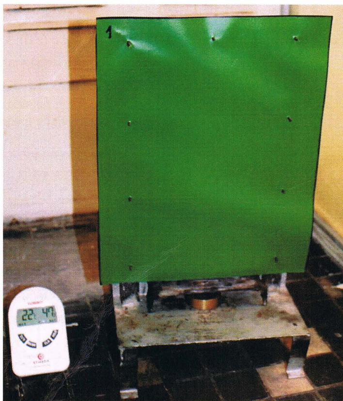
Fot. 1. Próbką folii PCV na stanowisku badawczym wg PB/BW/1, wykorzystywanym w CNBOP-PIB.
